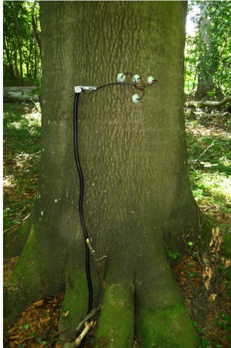
Abb. 3: Punkt-Dendrometer und Saftflusssensoren am Stamm einer 200jährigen Rotbuche auf dem großen Vilm. In hoher zeitlicher Auflösung werden Umfangsänderungen und Saftfluss im Xylem aufgezeichnet und die Daten drahtlos an einen Server übertragen
