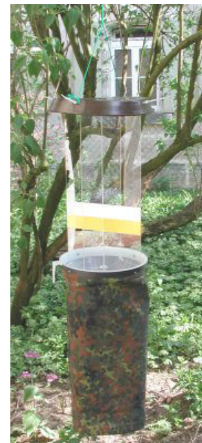
Lufteklektor nach RAHN © J. Schmidl, bioform
