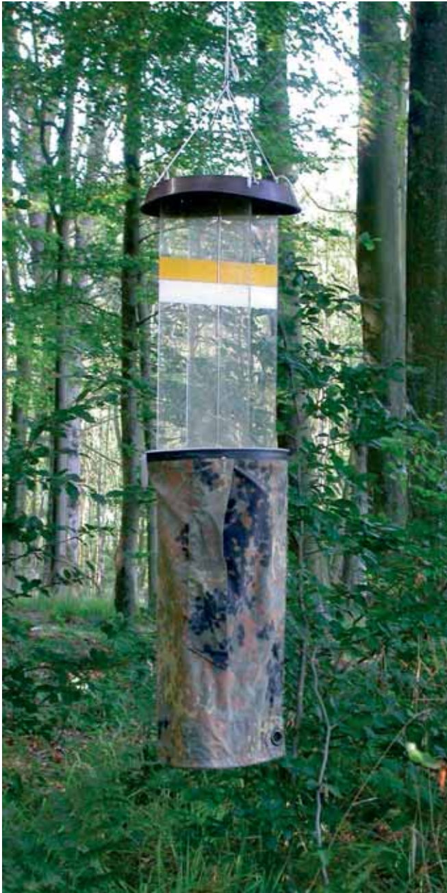
Foto 2-4: Aufbau des eingesetzten Luftklektors nach RAHN (Fa. bioform). Diese Fallen werden zum Betrieb an der Schnur in den Kronenraum gezogen. Die Arbeitshöhe lag im Gebiet zwischen 12 und 25 m.
