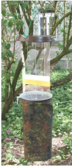
Luftklektor nach RAHN © J. Schmidl, bioform
