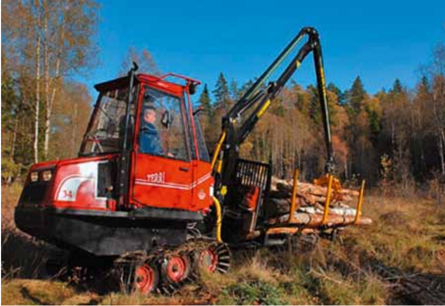
Foto 17: Die neu entwickelte TERRI 34 im Rückeeinsatz auf Nassstandorten (Quelle: Forsttechnik Volker Koch, Klocksinn; http://www.forsttechnik-koch.de/technik/terri/index.php ).
