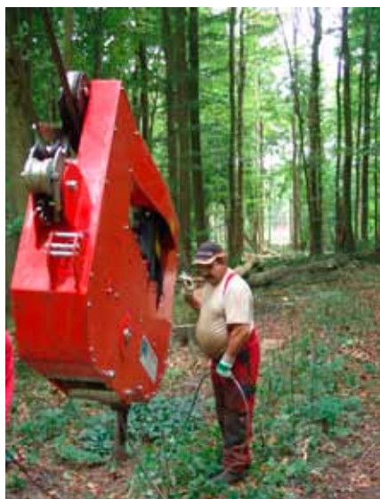
Foto 19 (links): Die im Projekt eingesetzte mobile Seilkrananlage vom Typ VALENTINI V 1000.
