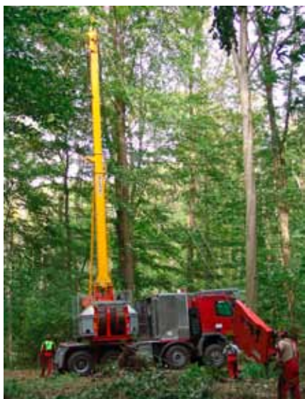
Foto 19 (links): Die im Projekt eingesetzte mobile Seilkrananlage vom Typ VALENTINI V 1000.
