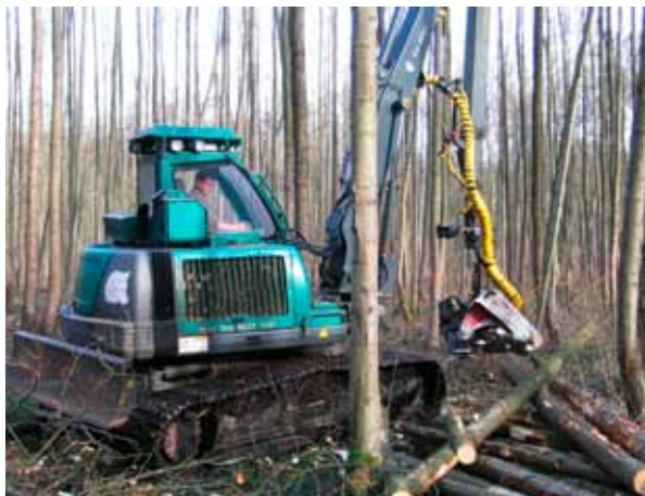
Abbildung 9: Der Drehkranz verhilft dem Harvester zu einer sehr guten Wendigkeit und damit zugleich Pfléglichkeit des Eingriffes.
