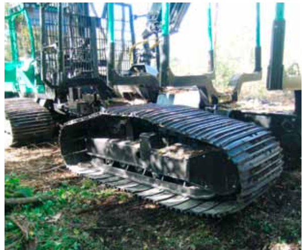
Abbildung 36: Der große Raupenforwarder vom Typ Prosilva 15-4ST Boghopper wiegt 22 t und ist mit 100 cm breiten Ketten ausgerüstet.
