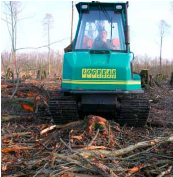
Abbildung 23: Eine Wurzelstockhöhe von 35 cm ist für die Überfahrt unproblematisch, da die Zugmaschine eine Bodenfreiheit von 38,5 cm aufweist.
