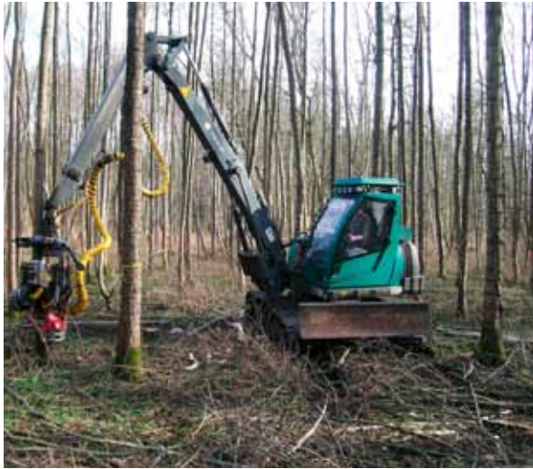
Abbildung 5: Der mittelgroße Raupenharvester vom Typ Neuson 9002HV wiegt 11 t und ist mit 600 mm Ketten (Dreistegketten) ausgerüstet.
