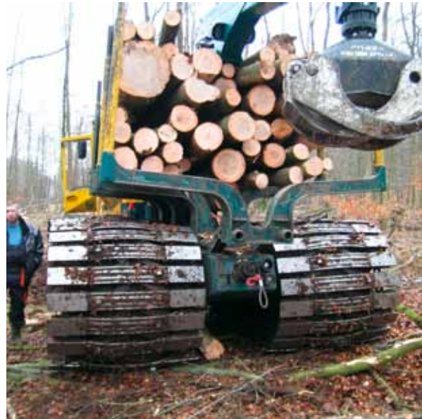
Abbildung 30: Der Radforwarder ist mit Moorbändern, die mit Metallplatten ergänzt wurden, ausgerüstet. Dies führt zu einer geraden und etwas größeren Aufstandsfläche.
