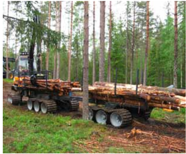
Abbildung 34: Die mittelgroße Kombimaschine vom Typ Timbear Lightfoot C als Forwarderversion wiegt 12 t und ist mit 78 cm breiten Ketten ausgerüstet. Seit 2014 nicht mehr hergestellt.
