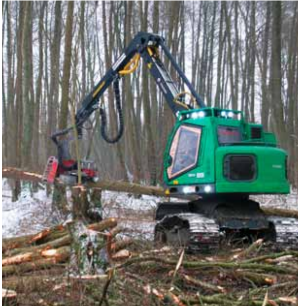
Abbildung 19: Der große Raupenharvester vom Typ Neuson 182HVT wiegt 20,5 t und ist ausgerüstet mit 700 mm breiten gekrüpfen Dreistegketten.
