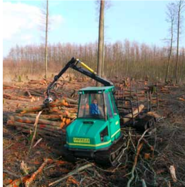
Abbildung 20: Bei voller Auslage des Ladekrans (6,1 m) können etwa 550 kg gehoben werden. Die Greiferöffnung des Ladekrans beträgt 1,04 m.
