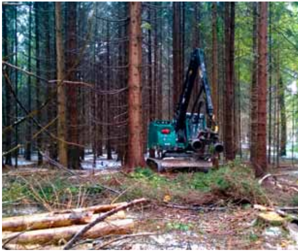
Abbildung 33: Der mittelgroße Raupenharvester vom Typ Neuson 132HVT wiegt 14,4 t und ist mit 60 cm breiten Dreistegketten ausgerüstet.
