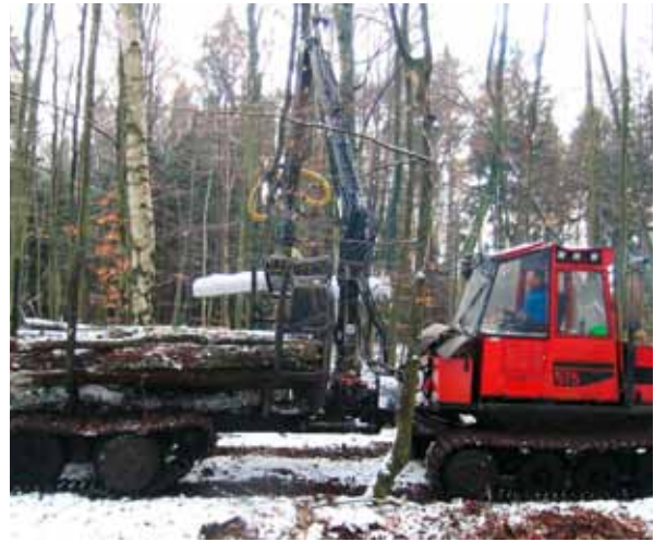
Abbildung 38: Der mittelgroße Raupenforwarder Farmi Trac 575 wiegt 8,9 t und ist mit 60 cm breiten Gummibändern mit Metallquerstegen ausgerüstet. Seit 2000 nicht mehr hergestellt.
