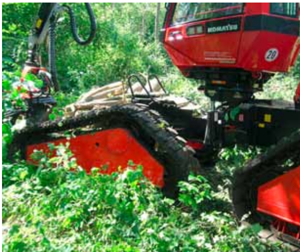
Abbildung 39: Der große Raupenharvester vom Typ Komatsu 911.5 X3M wiegt 24,2 t und ist mit 60 cm breiten Metallplatten mit Gummibeschichtung ausgerüstet.
