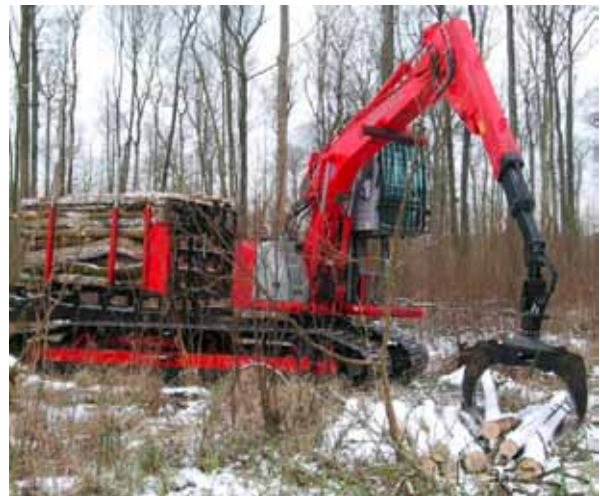
Abbildung 40: Der große Raupenforwarder von EMB Baumaschine Typ Elliator (Prototyp) wiegt je nach Ausstattung 23-30 t und ist mit 100 cm breiten gekröpften Dreistegplatten ausgerüstet.
