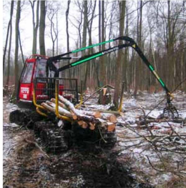
Abbildung 14: Der kleine Raupenforwarder vom Typ Terri 34 beim Rücken von Kurzholzsortimenten.
