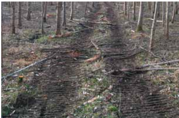
Abbildung 2: Fahrspurtyp 1: kaum eingewölbte Spuren beim Grundwasserstand von 60 cm unter Flur.
