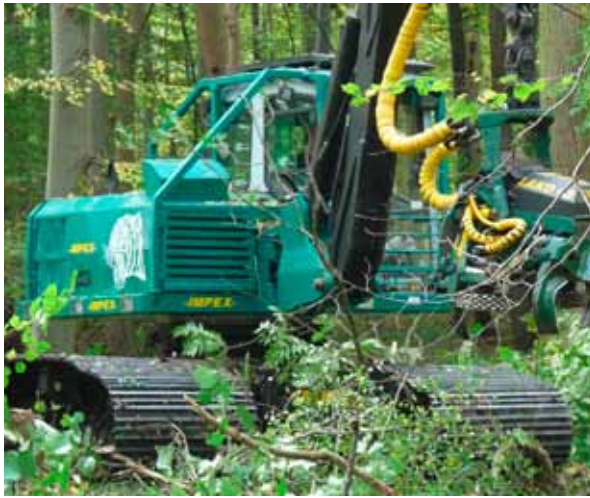
Abbildung 37: Der große Raupenharvester vom Typ T 18 (Minikönigstiger) wiegt 18 t und ist mit 105 cm breiten Dreistegplatten ausgerüstet.
