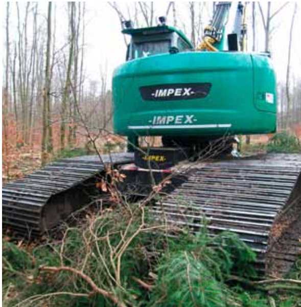
Abbildung 29: Die Aufstandsfläche des T 25 Moor beträgt 15,6 m 2 . Die durchschnittliche Gassenbreite beträgt 4,5 m.
