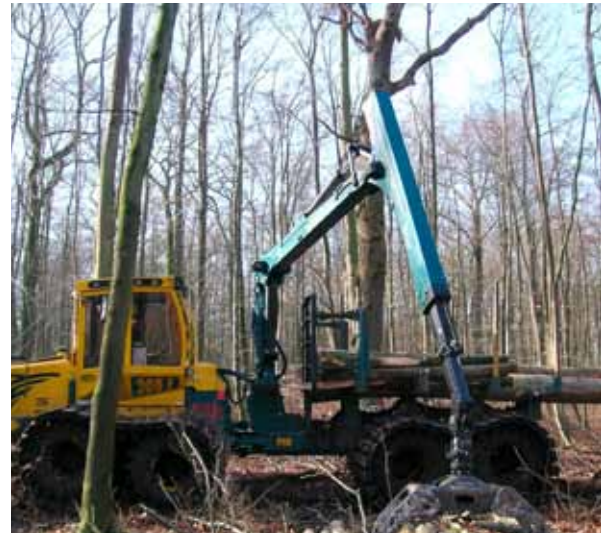
Abbildung 26: Der große Radforwarder HSM 208 F Moor lädt auch Stammholzabschnitte bis 6,5 m Länge.
