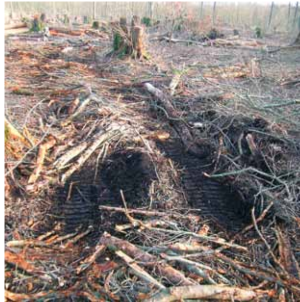
Abbildung 24: Gassenzustand (Spurtyp 2) nach zehn Lastfahrten bei einem Grundwasserstand von 70 cm und sehr viel Kronenholz auf der Rückegasse.
