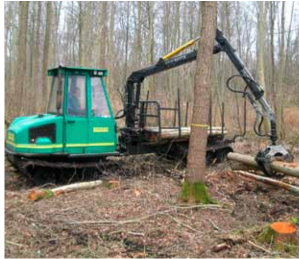
Abbildung 6: Der kleine Raupenforwarder vom Typ Logbear FH 4000 wiegt 5 t und hat 490 mm breite Gummibänder mit Metallquerstegen.
