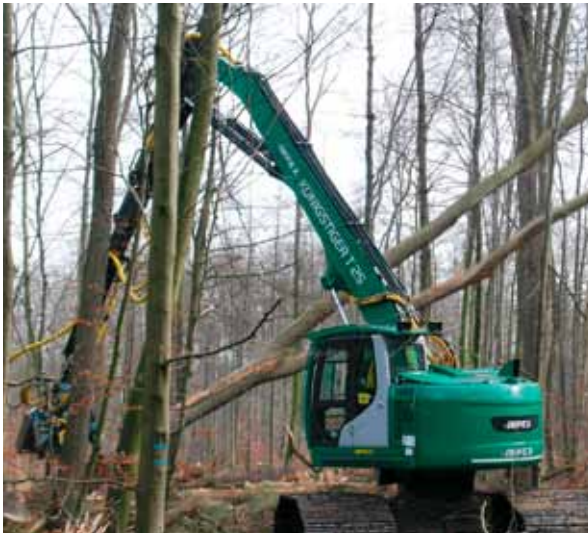
Abbildung 25: Der große Raupenharvester vom Typ Impex T 25 Moor wiegt 25 t und ist mit 1,30 m breiten Ketten ausgerüstet.
