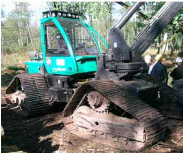
Abbildung 35: Der große Raupenharvester vom Typ Prosilva 910 wiegt 16 t und ist mit 80 cm breiten Metallketten ausgerüstet.
