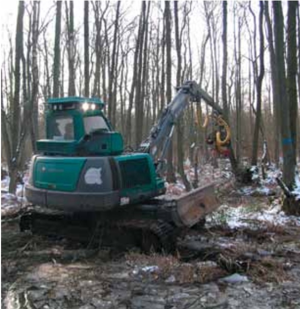
Abbildung 13: Raupenharvester vom Typ Neuson 9002HV bei der Durchforstung eines Roterlenbestandes mit Wasserüberstau.
