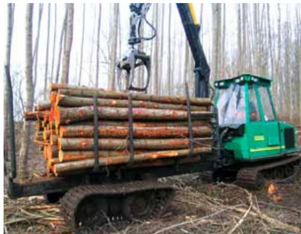
Abbildung 10: Die Gefahr des Einsinkens ist unter dem Rungenkorb am größten, da hier der rechnerische Bodendruck im beladenen Zustand 0,46 kg/cm 2 beträgt.
