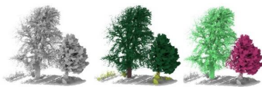
Abbildung 1: Schritte bei der KI-basierten Analyse von 3D-Punktwolken: Unbeschriftete 3D-Punktwolke (links), semantische Segmentierung (mittig) und Einzelbaum-Erkennung (rechts)
