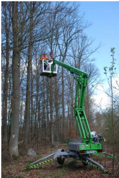
Arbeiten mit der 15,5 m hohen Anhängerbühne
